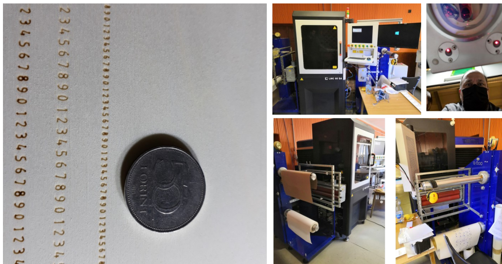
10. Ábra: Scanner fejes vágó és jelölő modul. Kiegészítve a tekercs adagoló rendszerrel. A tükrök sebessége 10000 mm/sec nyálábmozgási sebességet is lehetővé tesz.
