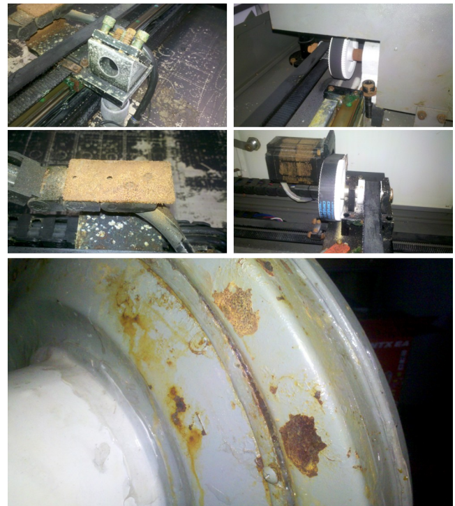
12. Ábra: A PVC vágás káros hatása, a savképződés ami akár 4-5 nap alatt is ilyen mértékű roncsolást eredményez
