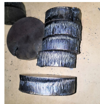
8. Ábra: A Bernaulli hatás és a csillapítatlan mechanika eredménye a visszafröcsögő és egyenetlen vágás
