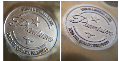
11. Ábra: Galvo fejes rendszerrel az elszívás és a passzív optikai elemek jelentős minőségi javulást eredményeznek
