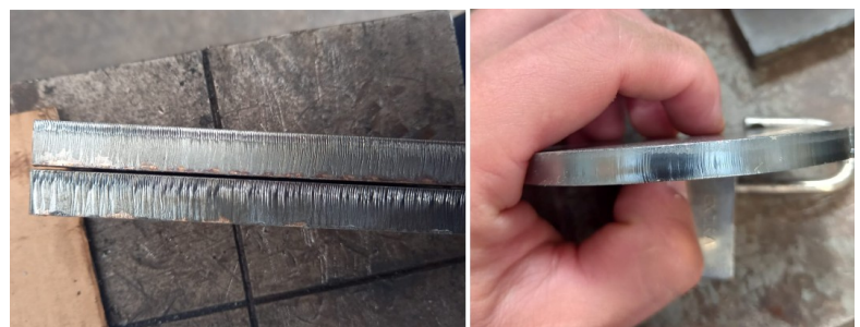
5. Ábra: Gázpulzátorral és hevített gáz befűtéssel elért minőség
